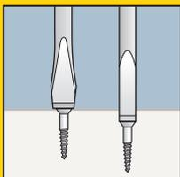
mécanicien, mais sélectionnez un tournevis d'électricien de la même largeur que la fente de la vis si vous devez enfoncer la vis sous la surface du bois sans l'endommager. Sélectionnez une pointe correspondant à la largeur de fente de la vis : une pointe trop large endommagera l'ouvrage tandis qu'une trop étroite risque d'endommager la fente.
